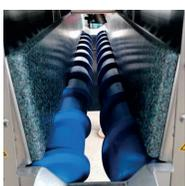
Deux déflecteur de chou réglables à l'aide de vis sont disposés sur le côté intérieur droit et gauche de la machine de nettoyage. Les déflecteurs de chou (caoutchoutés) permettent un guidage optimal du chou à travers la machine de nettoyage.
