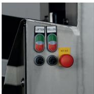
Un régulateur de fréquence permet de régler en continu la vitesse des rouleaux de nettoyage et de transport. Un nettoyage doux et soigneux des feuilles de chou à la structure fine et grossière est garanti.
