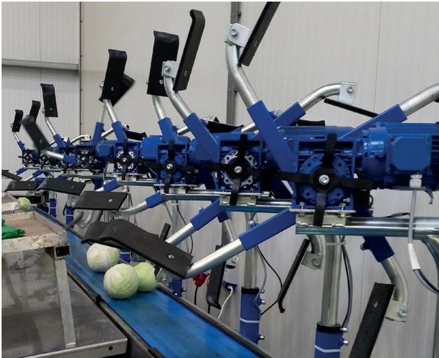
NOSMA vous propose également une technique complète de tri et de pesage pour vos choux pommés nettoyés. Différents triages sont possibles avec des intervalles de 50 grammes minimum. Le rendement horaire est d'environ 3000 choux.
