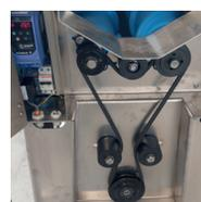
Les rouleaux de nettoyage sont actionnés par un moteur électrique de 0,55 kW. Un régulateur de fréquence et/ou des disques à courroie trapézoïdale plus petits ou plus grands permettent de régler la vitesse.
