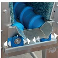
Il est possible de régler la distance entre les rouleaux de nettoyage à l'aide d'un boulon (trou oblong) et de l'ajuster ainsi à la taille du chou correspondante. Les petits rouleaux de nettoyage sont rapprochés, tandis que les grands sont éloignés les uns des autres.
