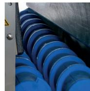
Grâce à deux tournant dans le même sens rouleaux de nettoyage, le chou est en rotation ou à travers l'unité de nettoyage.
