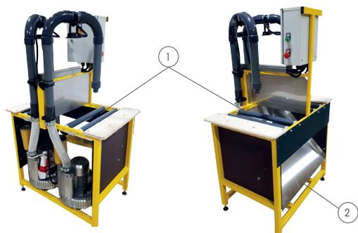
Station de nettoyage également disponible séparément, avec deux postes de nettoyage ou buses de nettoyage.
