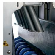
Placée au-dessus des rouleaux de nettoyage et dotée de buses de nettoyage ajustables, une gaine de buse pivotante et à angle entièrement réglable souffle sur les feuilles de chou détachées du trognon. Il est également possible de réguler la pression d'air
